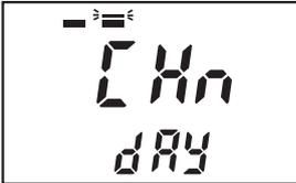
Presione la tecla **▶** para mover el indicador hacia lunes y seleccione lunes para cambiar (Mon se enciende) mediante las teclas **▼** o **▲** y repetir el procedimiento para seleccionar martes para cambiar (Tue se enciende) y presione la tecla **SET** para completar.
