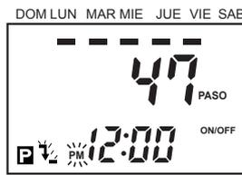
Seleccione PM mediante las teclas **▲** o **▼** y mueva el parpadeo a la posición de la hora mediante la tecla **▲**
