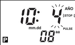
El parpadeo se mueve directamente hacia la posición del mes mediante la tecla **▶** y se establece el 4 mediante la tecla **▲** después de moverla hacia la posición de fecha mediante la tecla **▶** entonces presionar la tecla **SET**.
