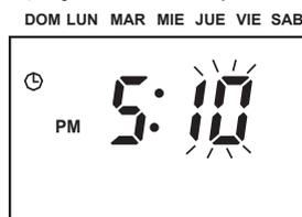
Presione las teclas ▲ ▼ para establecer 5 pm y mover el dígito intermitente a la posición min mediante la tecla ►. Presionar las teclas ▲ ▼ para establecer 10 min y presionar la tecla SET y se regresa al modo RUN cuando se presiona la tecla MODE por 3 seg.
