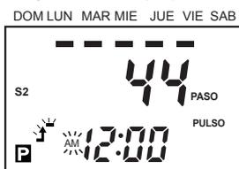
Presione la tecla **▶**, mueva la posición de hora parpadeante y seleccione PM mediante las teclas **▲** o **▼** cuando el tiempo ON este en la tarde.
