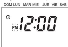
Presionar las teclas ▲ ▼ para seleccionar PM y mover el dígito intermitente para posicionar la hora mediante la tecla ►.
