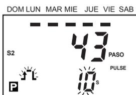
Presione la tecla **▲** para seleccionar la amplitud del pulso como 10 s (10 seg) y presione la tecla **SET**.
