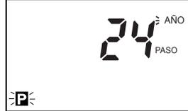
Presione la tecla **MODE** por 3 seg en modo RUN, "P" parpadea y presione la tecla **MODE** una vez, entonces, "P" y AÑO parpadean y presione la tecla **SET** para establecerlo.
