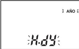
Presione la tecla **MODE** durante 3 seg para mover hacia el ajuste del grupo 1 en modo RUN y presionelo repetidamente hasta que "H.dy" este parpadeando en una parte de la pantalla secundaria y presione la tecla **SET**
