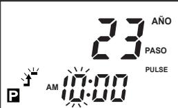
Presione la tecla **▼** dos veces para ajustar 10 y presione la tecla **SET** después de seleccionar 00 min **SET**.
