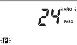
La tecla **MODE** es presionada por 3 seg en modo RUN, "Prog P1" parpadea y presione **MODE** de nuevo, "Prog P2 AÑO" parpadea y presione la tecla **SET**.
