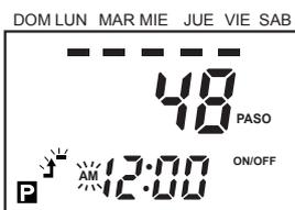
La tecla **▶** es oprimida mueve la posición de hora parpadeante y seleccione PM mediante las teclas **▲** o **▼** cuando el tiempo ON esta en la tarde.
