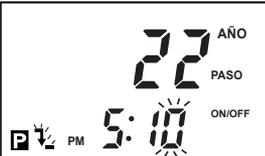
Mueva el parpadeo hacia la posición de minuto después de ajustar 5 mediante la tecla **▲** y ajuste el minuto como 10 y presione la tecla **SET**.
