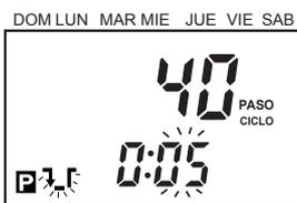
Presione la tecla **▶** para mover la posición del minutero parpadeante y ajuste como 5 min mediante la tecla **▲** y oprima la tecla **SET**.
