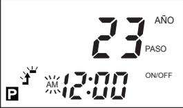
La tecla **▶** es presionada, mueva el parpadeo hasta la posición de hora y seleccione PM mediante las teclas **▼** o **▲** cuando el tiempo ON este en la tarde.
