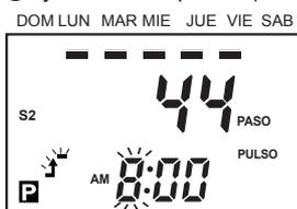
Ajuste 8:00 mediante la tecla **▼** y presione la tecla **SET**.
