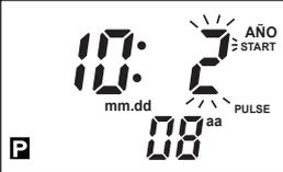
Presione la tecla **▲** dos veces para ajustar 08 (año 2008) y mueva hacia la posición mes mediante la tecla **▶**. Ajuste Oct mediante la tecla **▼** y mueva hacia la posición de fecha mediante la tecla **▶** y presione la tecla **▲** después establezca 2 mediante la tecla **SET**.
