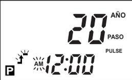
La tecla **▶** es presionada, mover el parpadeo hacia la posición hora y seleccionar PM mediante las teclas **▼** o **▲** cuando el tiempo en ON este en la tarde.
