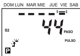
Presione la tecla **▶** para mover el indicador hacia el Lunes, se encendera cuando las teclas **▲** o **▼** son presionadas y se mueve hacia martes mediante la tecla **▶**. Presione la tecla **SET** después de encender el martes, miércoles, jueves y viernes.
