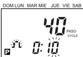
Presione la tecla **▶** para mover la posición del minutero parpadeante y ajustarlo como 10 min mediante la tecla **▲** y presionar la tecla **SET**.
