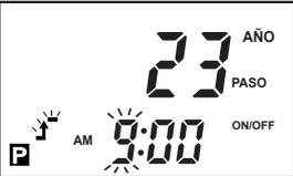
Presione la tecla **▼** para ajustar 9 y presione la tecla **SET** después de seleccionar 00 min.
