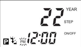
Seleccione PM mediante las teclas **▼** o **▲** y mueva el parpadeo hacia la posición hora mediante la tecla **▶**.
