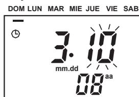
Pulse las teclas ▲ ▼ para ajustar 08 (año 2008) y mover el dígito intermitente a la posición de mes mediante la tecla ►. Presione la tecla SET después presione ▲ o ▼ para establecer el día 10.
