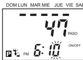
Mover el parpadeo a la posición minuto después establecer 6:00 mediante la tecla **▲** y ajuste el minuto como 10 y presione la tecla **SET**
