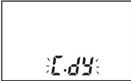
Presione la tecla **MODE** por 3 seg para mover al ajuste del grupo 1 en el modo RUN y presionelo repetitivamente hasta que **C.dy** parpadee en una visualización secundaria y presione la tecla **SET**
