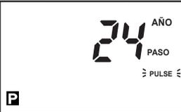
La tecla **▲** se presiona cuando ON/OFF esta parpadeando para ajustar el modo PULSO y presionar la tecla **SET**.
