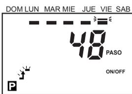
Pulse el botón **▶** para mover el indicador al lunes, que se ilumina cuando **▲** o **▼** se pulsan las teclas y mover hasta el martes mediante la tecla **▶**.
